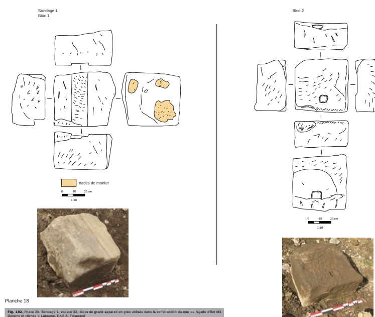
Fig. 102. Phase 2b. Sondage 1, espace 32. Blocs de grand appareil en grès utilisés dans la construction du mur de façade d'îlot M3. Dessins et clichés Y. Labaune, DAO A. Tisserand
