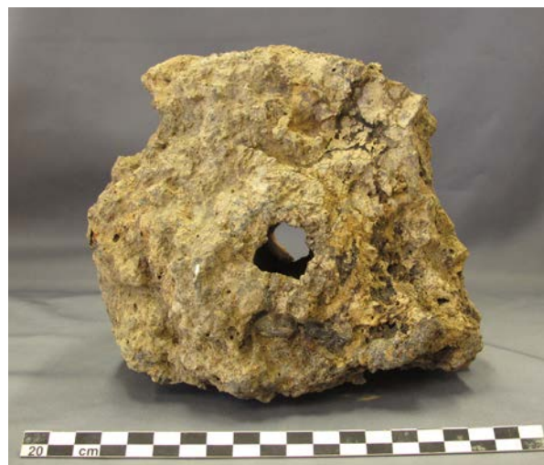
Fig. 37. Phase 1a. Sondage 1, espace 12. Fragment de bloc-tuyère découvert dans le comblement de l'égout St. 1. Cliché M. Loire
