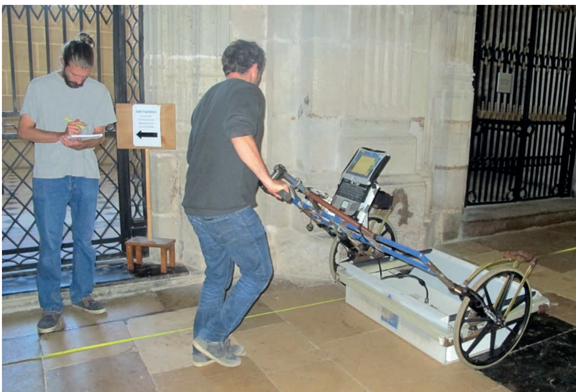
Fig. 6. Phase préliminaire de prospections géophysiques (méthode radar) dans la nef, les collatéraux, le transept et le chœur par la société Analyse Géophysique Conseil Sarl : vue générale de l'équipement. Cliché Y. Labaune.
