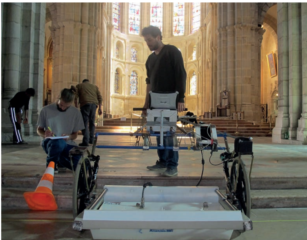
Fig. 5. Phase préliminaire de prospections géophysiques (méthode radar) dans la nef, les collatéraux, le transept et le chœur par la société Analyse Géophysique Conseil Sarl. Cliché Y. Labaune.
