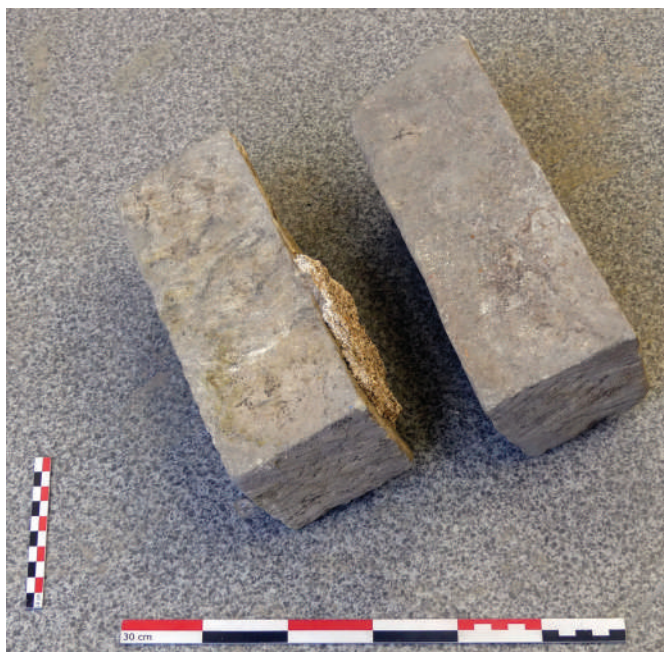
Fig. 15. Moellon de chaînage d'angle en grès fin du Rhétien (L/4000).
