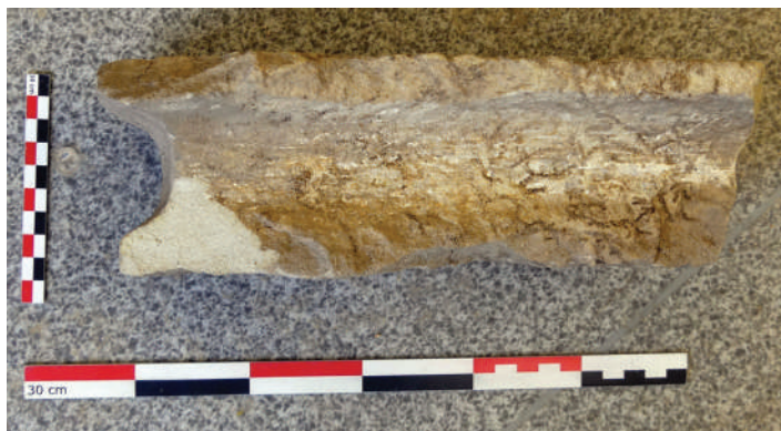
Fig. 19. Moellon de chaînage d'angle en grès fin du Rhétien, avec moulure en creux (L/4000).
