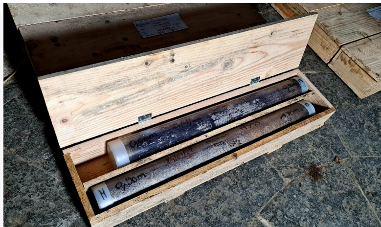
Fig. 12. Vue de détail des tubes de plexiglas accueillant des tronçons de carottes, stockés dans leur caisse en bois. Cliché Yannick Labaune
