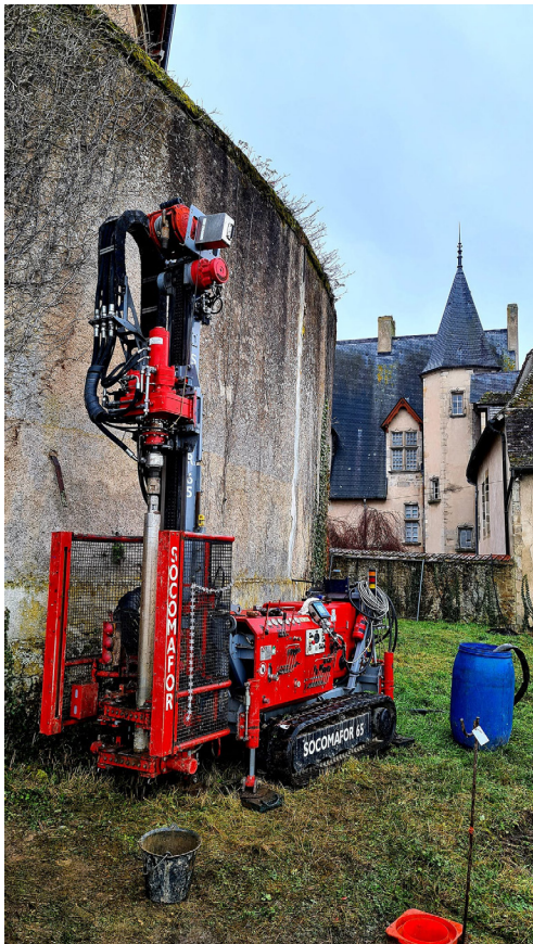
Fig. 8.1. Cliché de la carotteuse utilisée dans le cadre de cette opération, permettant d'extraire des carottes non bouleversées conservant la stratigraphie originelle.
