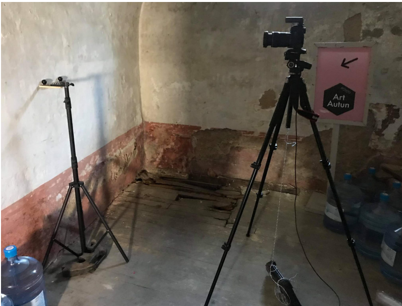
Fig. 11. Cadrage de l'appareil photographique pour des prises de vue en RTI.
