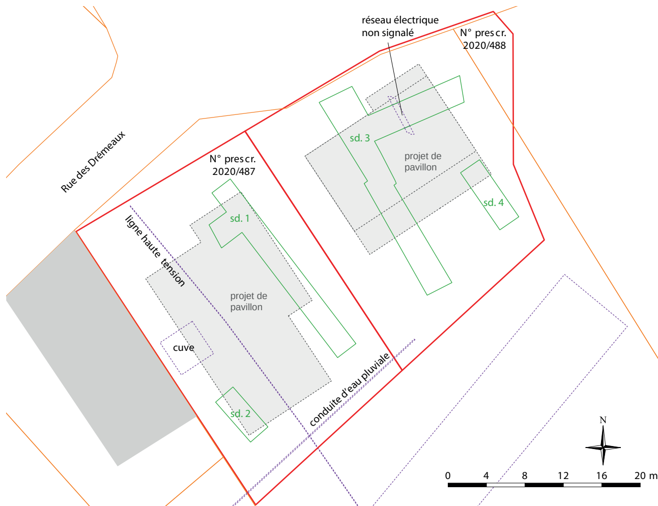
Fig.1 Localisation des sondages et contraintes de réseau © S. Alix, Inrap
