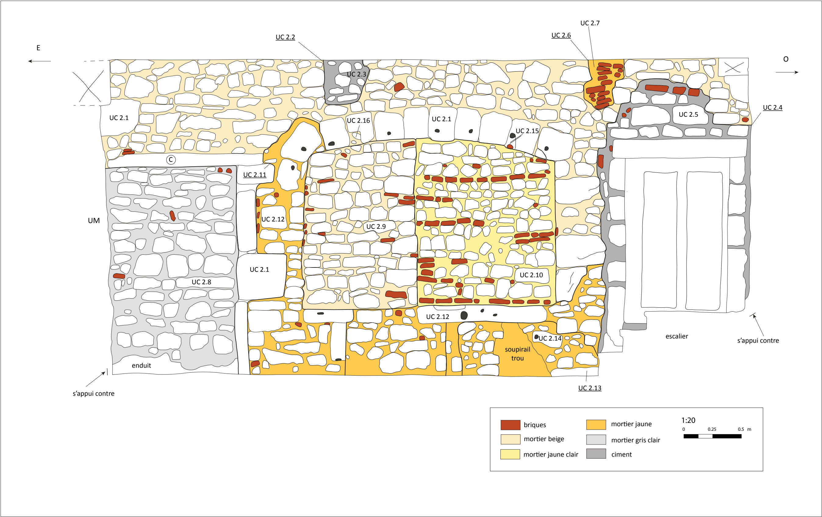
Relevé des matériaux de construction et UC de l'UM2.
