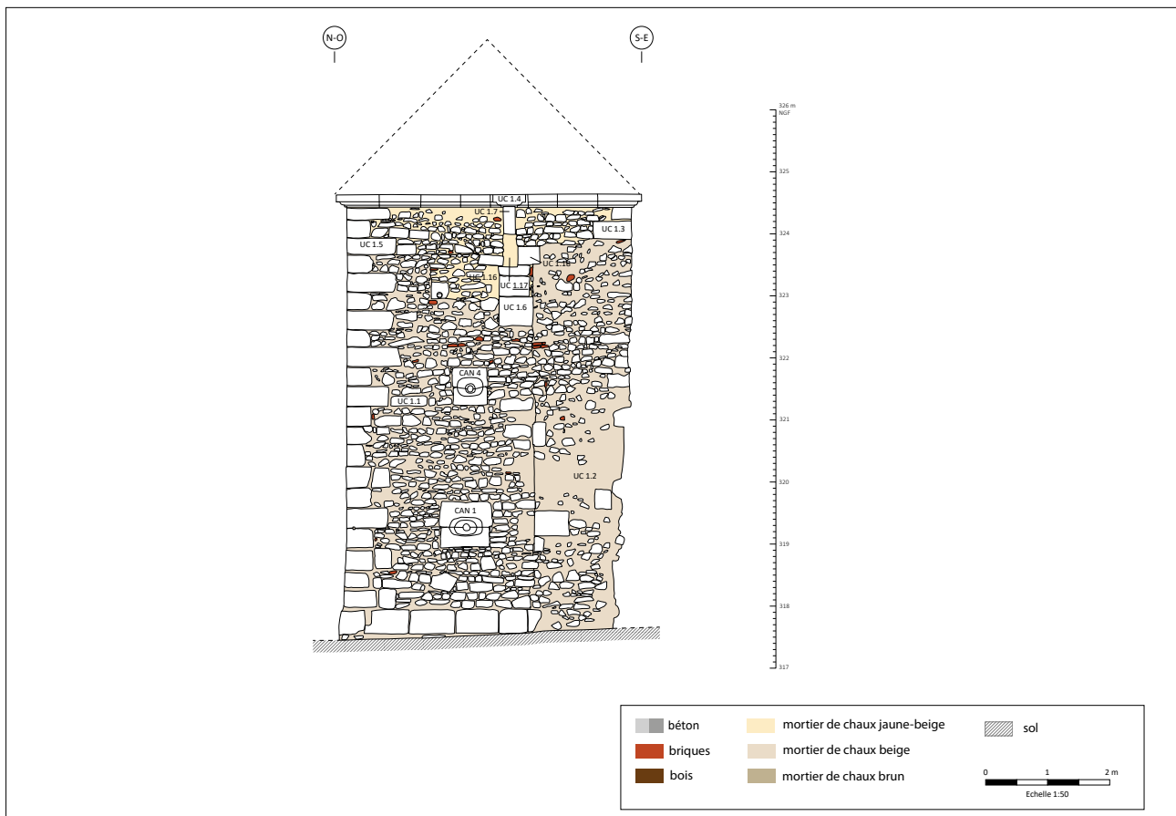
Fig. 10. Relevé des matériaux de construction et des UC du parement extérieur de l'UM 1.
