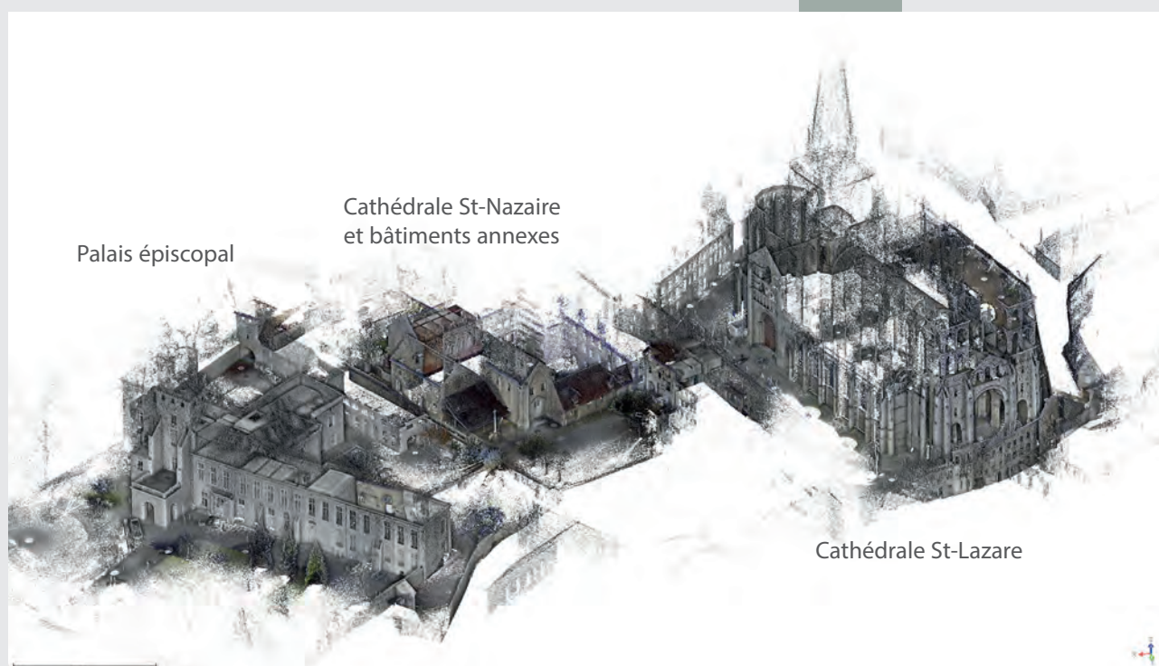
Fig. 3 Nuage de points du groupe épiscopal d'Autun obtenu par balayage laser (Relevé et traitement Camilla Cannoni).
