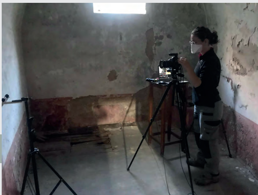
Fig. 4 Réalisation des prises de vues par RTI dans la prison panoptique (Cliché A. Roger)
